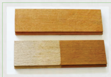
» شکل ۷. تصویر مربوط به آزمایش دو قطعه چوب تحت اثر عوامل جوی در یک دوره شش ماهه: چوب معمولی و بدون پوشش در بالا و چوبی که تنها یک نیمه آن (نیمه سمت چپ) مسلح به پوشش لیگنول است.
